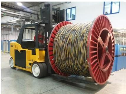
Durch seine sehr kompakte und robuste Bauweise und die Cushionbereifung ist dieser Stapler, mit einer maximalen Tragfähigkeit von 16.000 kg, ideal zum innerbetrieblichen Transport von schweren Gütern in beengten Räumen. Die zwischen den Achsen platzierten Batterien verleihen ihm einen extrem niedrigen Schwerpunkt, um maximale Stabilität zu gewährleisten. Die seitliche Batterieentnahme ermöglicht einen schnellen und sicheren Batteriewechsel.
